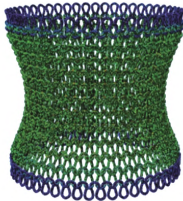
图13 筒状针织物拉伸时模拟效果
